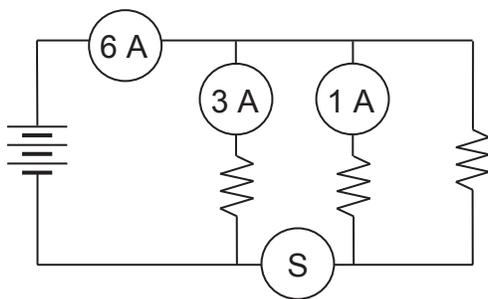
Si tres de los amperímetros registran una corriente eléctrica de intensidad 6 A, 3 A y 1 A, respectivamente, ¿cuánta intensidad de corriente eléctrica registra el amperímetro S?
